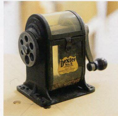
NYに住んでいたころに見つけた1940年代の手動鉛筆削り。米軍仕様と推察。金属の重量で安定感は抜群。中が見える透明部分は、なんとセルロイド製！
